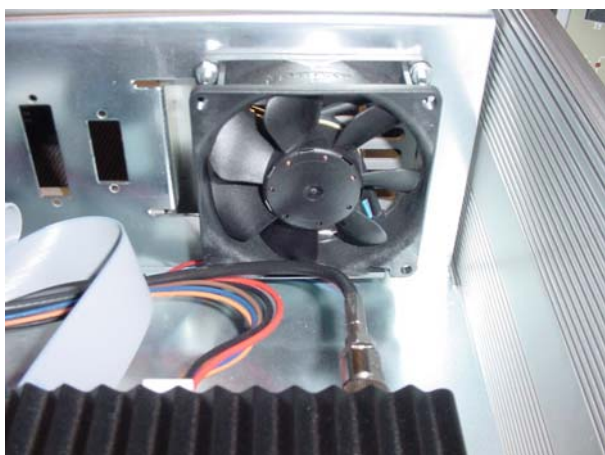
Felaktigt monterad fläkt, produktskylden syns ej.
