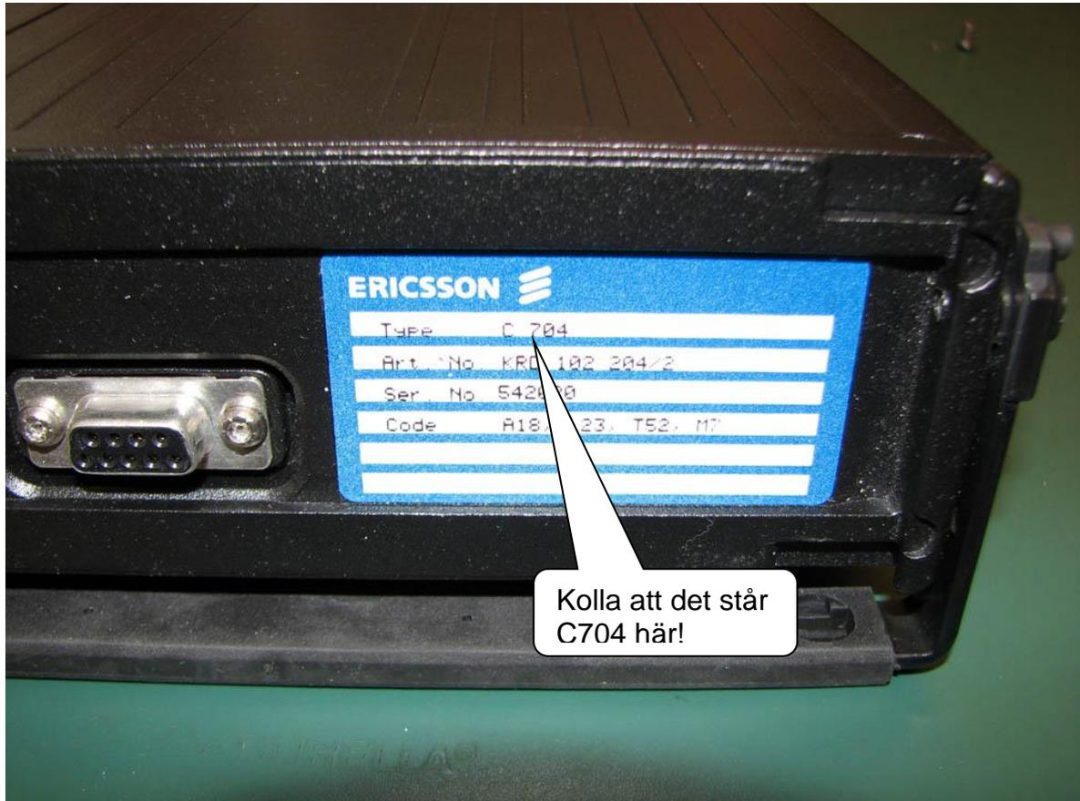
Kolla typskylten så det är en typ C704 (138 – 174 MHz). Om det är en C702 eller C705 så kommer detta inte att funka. Kolla också att radion är hel och fungerar innan du börjar. Saknar radion typskylt så är det troligen stöldgods.
