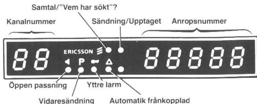
Fig 5. Stationens display med kanal- och nummerindikator samt funktionssymboler.
